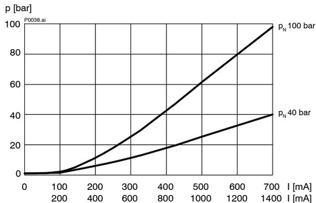
$p = f(I)$  Druck-Verstellverhalten (bei  $Q = 0,3$  l/min)
