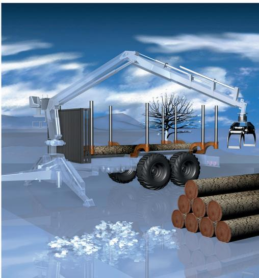
Zu den Hauptfunktionen der Kransteuerung zählen neben dem Schwenken des Krans das Verfahren von Hauptarm, Ausleger und Teleskop sowie Drehen, Öffnen und Schließen der Zange. Mit der erweiterten Funktionalität sind Abstützen sowie „Tilt Funktion“ (waagrecht Stellen) des Krans bei Bergfahrten möglich
