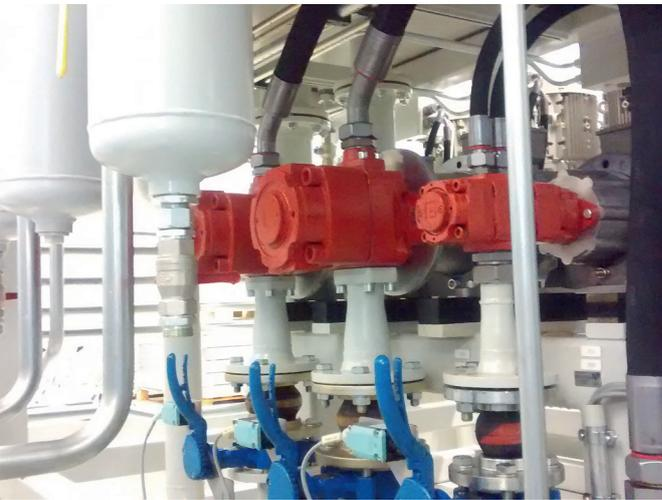
Aggregate-Hersteller finden bei Bucher Hydraulics die für die jeweilige Anwendung optimale Pumpe. Als Erweiterung der QX-Baureihe steht mit der innovativen QXEH/QXEM nun ein einstufiges Triebwerk für den Druckbereich bis 280 bar zur Verfügung. Ob Antriebe mit konstanter oder variabler Drehzahl: Anwender können sich auf die konstruktionsbasierte Betriebssicherheit der Pumpe mit niedrigen Betriebsgeräuschen verlassen, die einen großen Temperatur- und Viskositätsbereich abdeckt.
