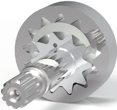
Der ruhige Druckaufbau entlang des Halbmondes mit sehr langer Druckaufbaustrecke ist das Hauptmerkmal der nicht-kompensierten QXEH/QXEM. Die Ritzelwellen-Technologie (Ritzel und Welle als ein Teil) mit frei laufendem Getriebe in hochpräzise gefertigten Kammern und komplett symmetrische Saug- und ruckbereiche sind die Basis für geringe Geräuschemissionen und gute Regelbarkeit. Gleichzeitig gewährleistet diese Konstruktion hohe Betriebssicherheit und damit die Steigerung der Produktivität.
