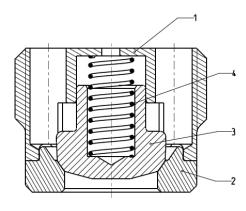
Die Rückschlagventile der Baureihen RKVG und RKVE zeichnen sich durch die geführte Ventilkugel mit innenliegender Feder aus. Der Hub wurde zur Optimierung der Delta-P-Werte des Ventils vergrößert. Gehäuse und Sitz sind reibschlüssig miteinander verbunden und ebenso wie die Kugel gehärtet.
