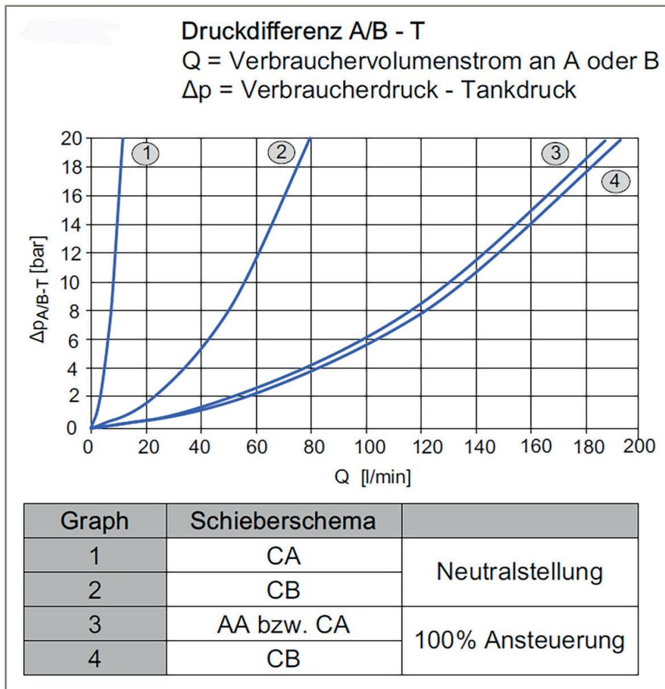
Energie sparen ist einer der Vorzüge des Proportional-Wegeventil SC12. Wenn Öl vom Verbraucher über das Ventil zurück zum Tank fließt, entsteht abhängig vom Volumenstrom  $Q$  ein Gegendruck im Ventil. Je geringer diese Druckdifferenz (Delta-P A/B zu T) innerhalb des Ventils ist, desto besser fällt die Energiebilanz aus.
