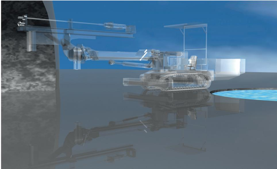
Beim Einsatz in Erdbohrgeräten dient das SC12 Funktionen zur Bewegung von Auslegern, Stützzylindern, Teleskop oder Abstützung. Hier kommt es auf hohe Zuverlässigkeit an, da das Gerät auch bei einem möglichen Gegendruck mit der eingestellten, definierten Geschwindigkeit arbeiten muss. Diese Funktion erfüllt die vorgeschaltete Druckwaage des Proportional-Wegeventils SC12.
