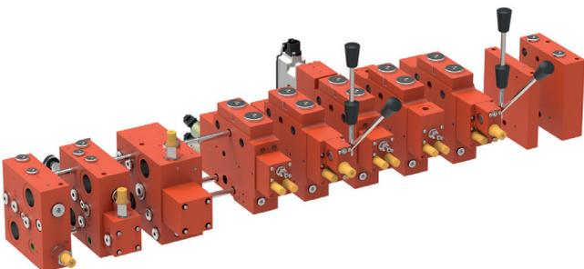
Der Baukasten des SC12 von Bucher Hydraulics besteht im Wesentlichen aus Eingangs-, Verbraucher- und Endsektion, wie hier im Bild von links nach rechts dargestellt. Die Sektionen können exakt der Applikation entsprechend zusammengestellt werden, wobei bis zu acht Verbrauchermodule in zahlreichen Varianten einsetzbar sind.
