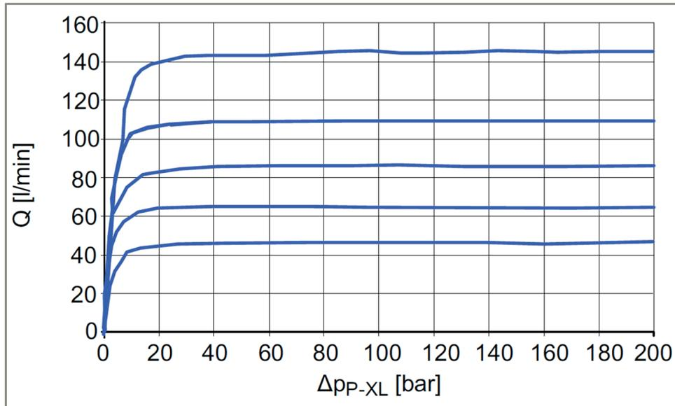
Mit einem Delta-P von nur 13 bar setzt das Proportional-Wegeventil SC12 neue Maßstäbe. Der frühe Stromregelbeginn bei diesen geringen Druckdifferenzen wurde bei vergleichbaren Ventilen im Markt bisher nicht erreicht. Das optimierte Regelverhalten verringert Verluste am Ventil, was die Betriebskosten senkt und die Produktivität erhöht.
