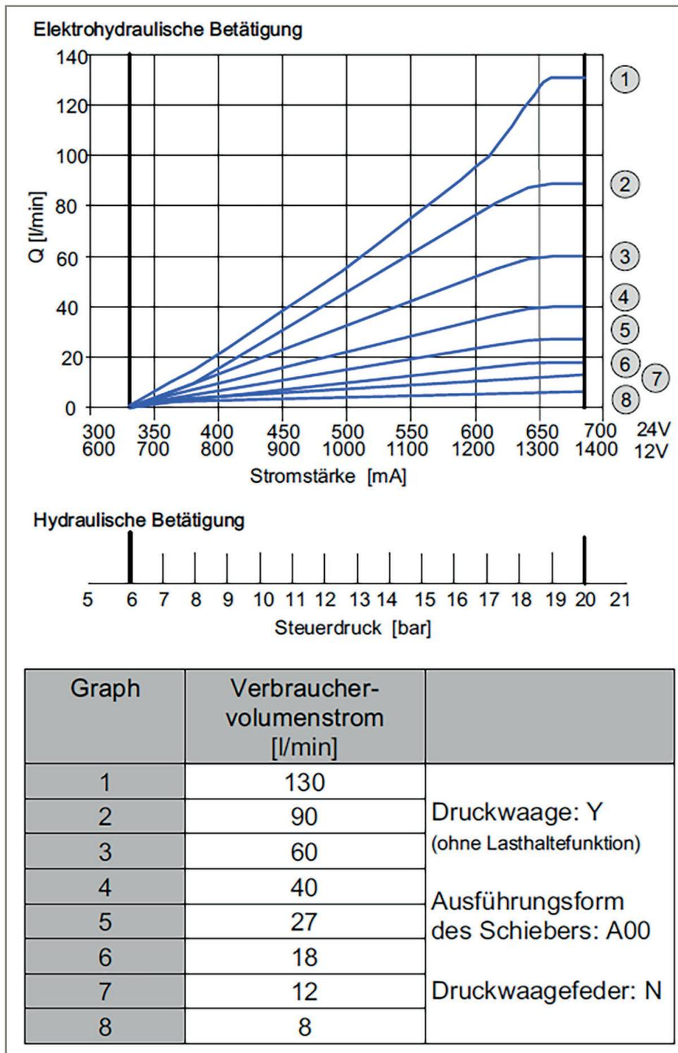
Anhand der Kennlinien für die elektrohydraulische Betätigung zeigt sich, wie gut das proportionale Verhalten des Volumenstroms über die Stromstärke bzw. den Steuerdruckbereich ist.
