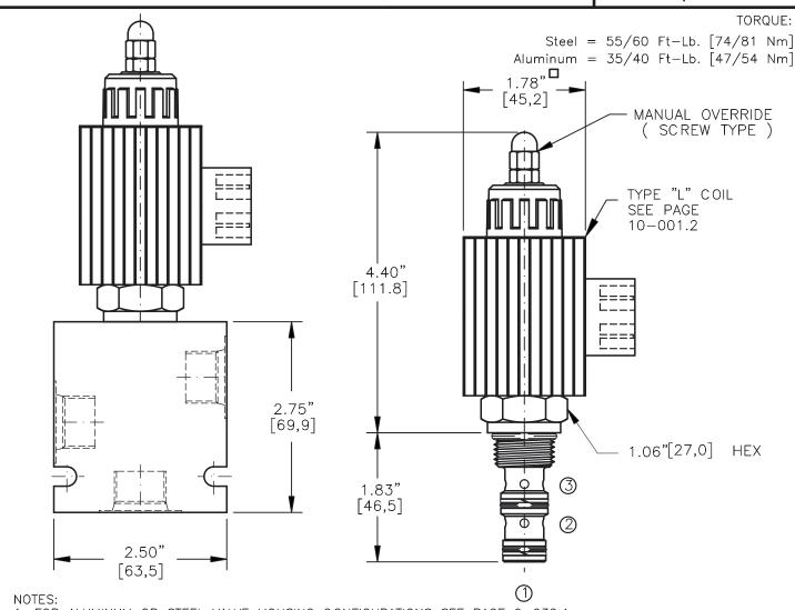
1. FOR ALUMINUM OR STEEL VALVE HOUSING CONFIGURATIONS SEE PAGE 0-032.1 2. SOLENOIDS AVAILABLE WITH DIODES - CONSULT FACTORY.
