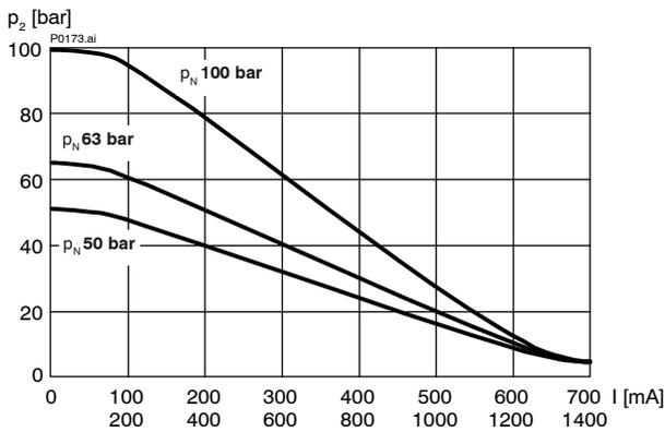
$p = f(I)$  Druck-Verstellverhalten ( $Q = 5 \text{ l/min}$ )
