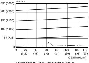
Druckeinstellung Typ M / pressure range type M  $p_{_N}$  = 210 bar (3000 psi) 1) Einsatzgrenze / Application limit
