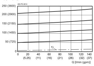
Druckeinstellung Typ M / pressure range type M  $p_N$  = 210 bar (3000 psi)
