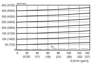
Druckeinstellung Typ N / pressure range type N  $p_N$  = 350 bar (5000 psi)
