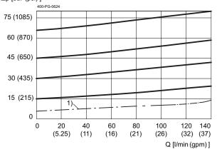
Druckeinstellung Typ L / pressure range type L  $p_N = 350$  bar (5000 psi)
