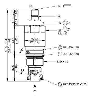
Version "H": Einstellschraube mit Handrad Version "H": adjustment screw with handknob
