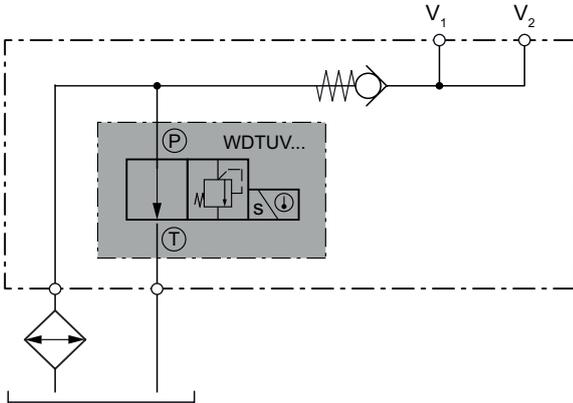
Steuerblock mit integriertem Kühler
