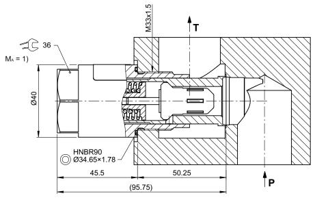
Thermoelement > 65  $^{\circ}$ C - Verbindung P nach T geschlossen/ Thermostat element > 65  $^{\circ}$ C - connection P to T closed
