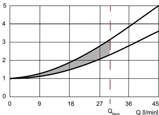
Berechnung des Aufsteuerdruckes
