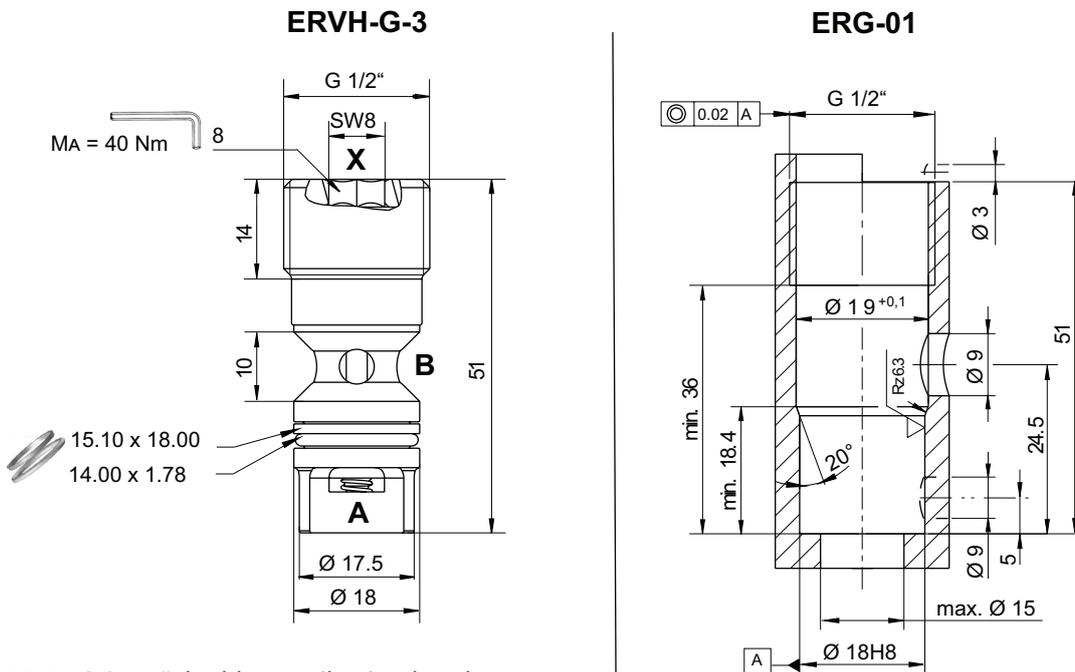
**ERVH-G-3** = Rückschlagventil / Einschraubpatrone
