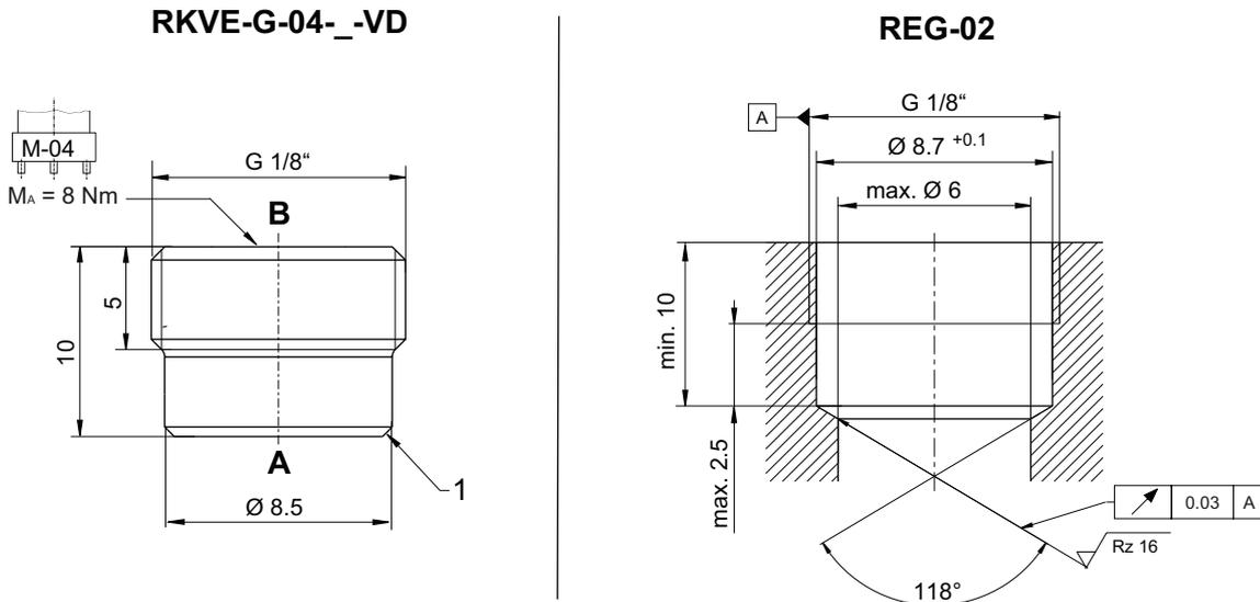
**RKVE-G-04-\_-VD** = Rückschlagventil / Einschraubpatrone
