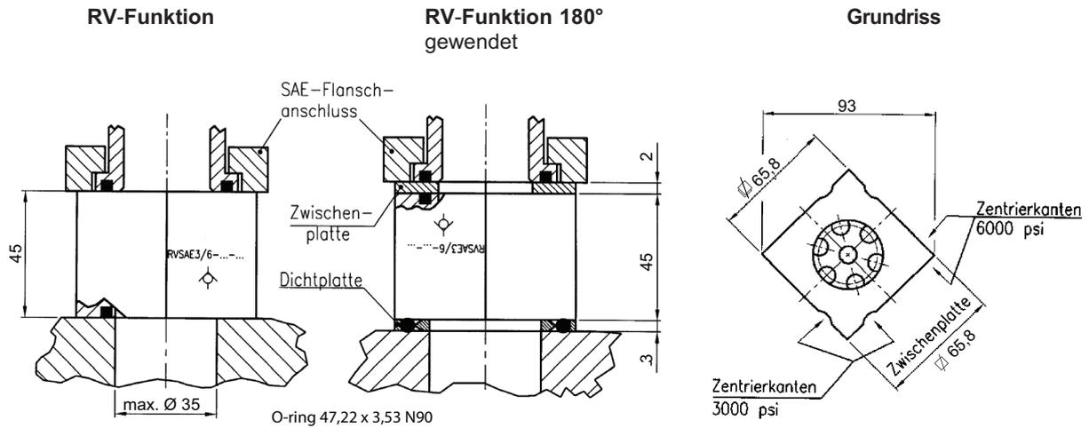
**Abmessung SAE Flanschanschlüsse**
