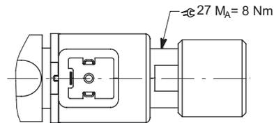
Q<sub>0</sub> bis Q<sub>max</sub> = ca. 3,5 Umdrehungen am Handrad
