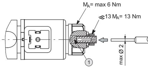
Durch drücken des Nothand-Pins (1) wird der Proportionalmagnet ON/OFF geschaltet
