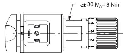
Q<sub>0</sub> bis Q<sub>max</sub> = ca. 1 Umdrehung am Handrad
