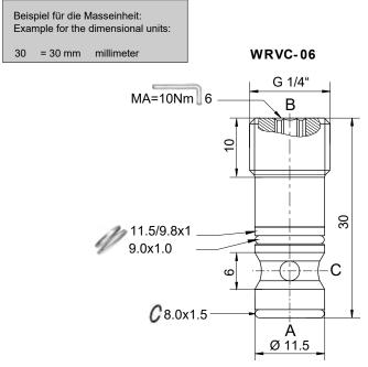
Für Bohrungsform WRG-01 / For cavity WRG-01 Die angegebenen Maße gelten für den eingebauten Zustand The dimensions specified apply to the mounted state.
