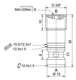
Für Bohrungsform WRG-01 / For cavity WRG-01 Die angegebenen Maße gelten für den eingebauten Zustand The dimensions specified apply to the mounted state.
