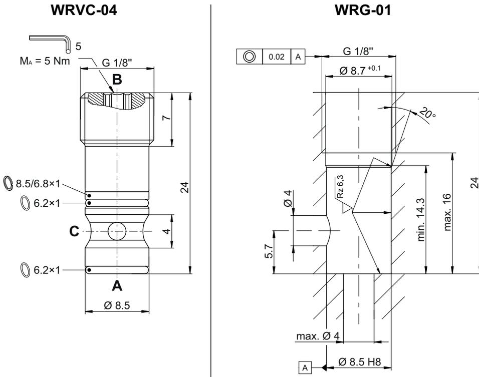
**WRVC-04** = Wechsel-Rückschlagventil / Einschraubpatrone
