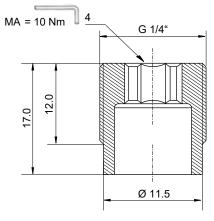
Die angegebenen Maße gelten für den eingebauten Zustand. The dimensions specified apply to the mounted state.
