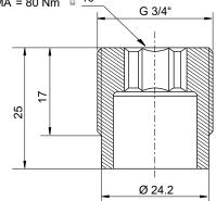
Die angegebenen Maße gelten für den eingebauten Zustand. The dimensions specified apply to the mounted state.
