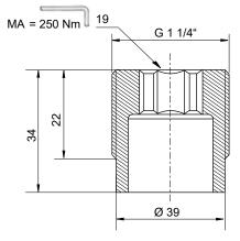
Die angegebenen Maße gelten für den eingebauten Zustand. The dimensions specified apply to the mounted state.
