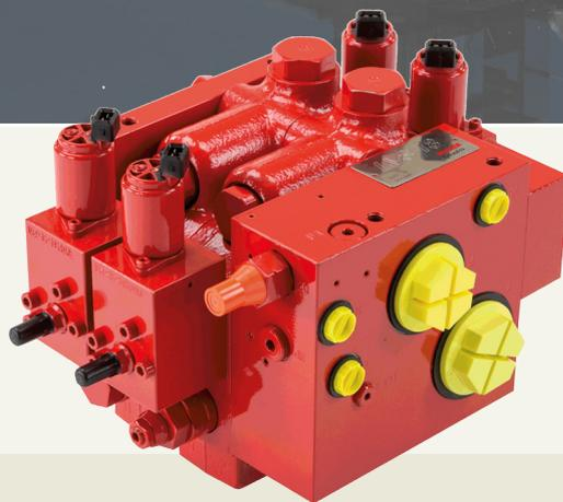
Nachgeschaltete Individual-Druckwaage und Mengenteilerprinzip
