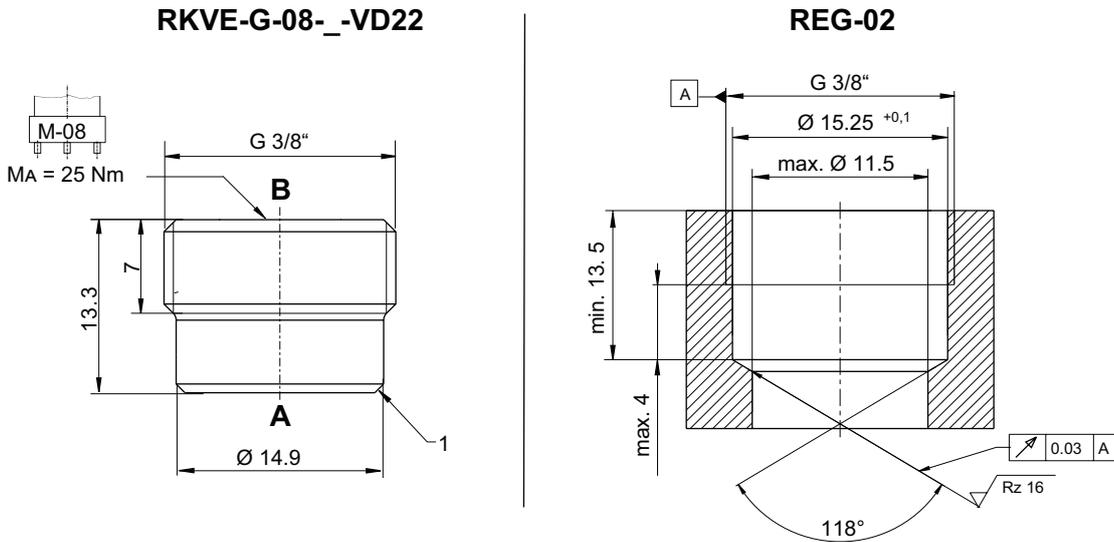
**RKVE-G-08-\_-VD22** = Rückschlagventil / Einschraubpatrone
