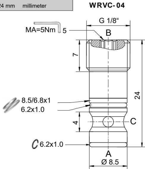
Für Bohrungsform WRG-01 / For cavity WRG-01
